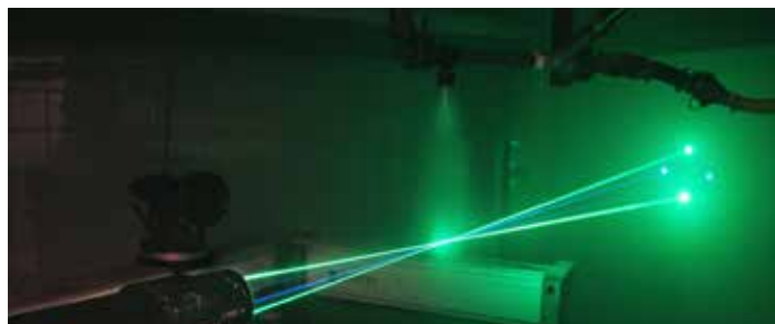
Laser PDA pour mesurer la vitesse et la taille des gouttes de pulvérisation
